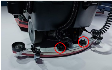
第一步：通过十字旋钮将吸水扒固定在摆尾结构上。
