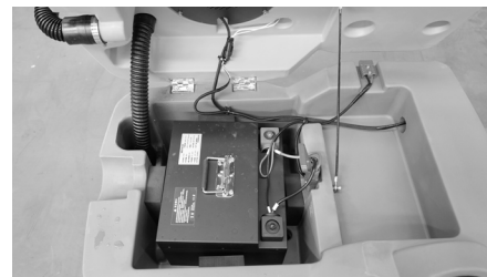
▼磷酸铁锂电池
